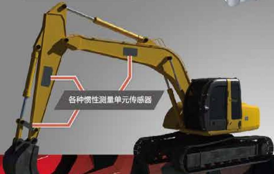
ICT液压挖掘机 2D控制系统构成
